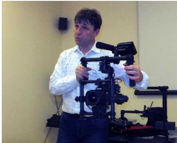
L'attrezzatura GIMBAL. Si notano le maniglie per maneggiarla e sostenerla, la frame mobile (comandata dai servomotori) che supporta la macchina da ripresa (in questo caso una macchina fotografica utilizzata nel modo "cinema"). Superiormente si vede un monitor di servizio che permette di puntare e comporre la scena con la massima precisione ed efficacia.
